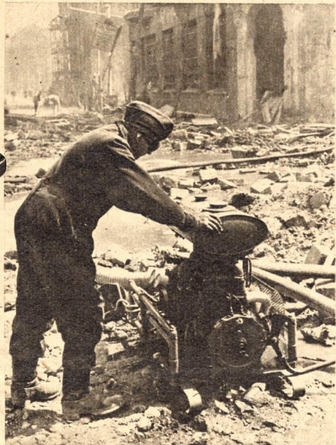
Hier ist eine Tragkraftspritze eingesetzt, die Wasser aus einem Teich ansaugt und unter hohem Druck in die Schlauchleitungen pumpt
